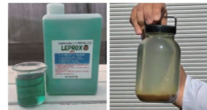
ミネラルイオン溶液 [LEPROX] 処理された汚水。分解汚泥が下に沈殿している。
