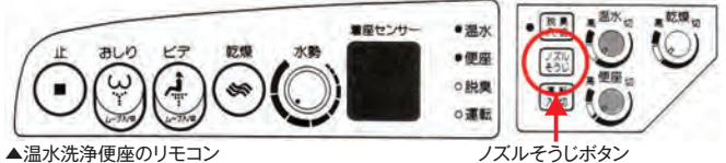
▲温水洗浄便座のリモコン
